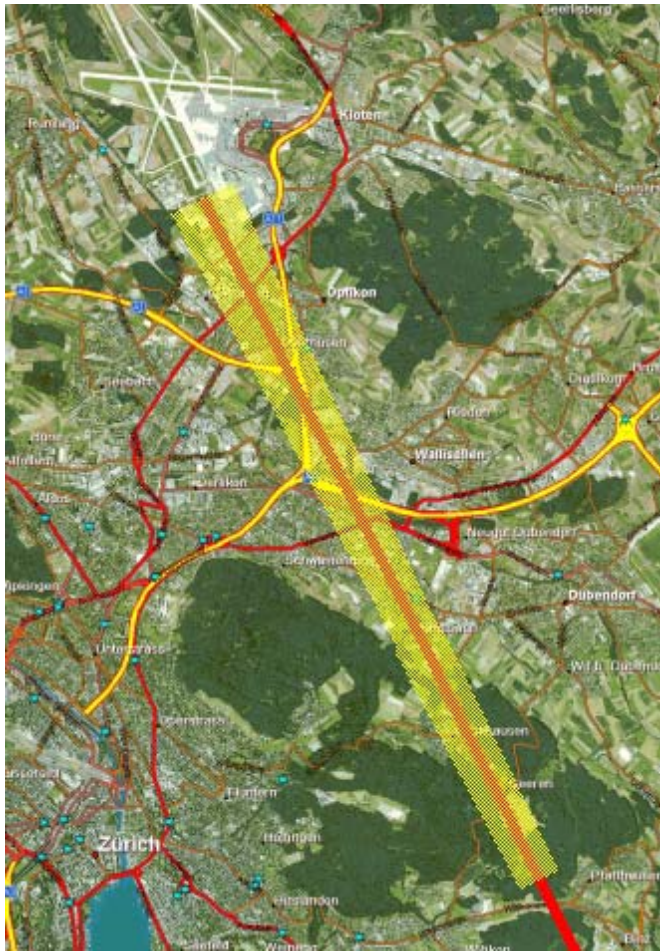
Bereich der Dachziegelklammerung
